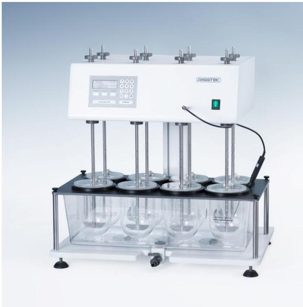
*Für Nanoformulierungen sind Freisetzungstest bei 37°C oft nicht anwendbar. Mit einer reduzierten Temperatur erreicht man mess- und nachvollziehbare Freisetzungskurven!*
