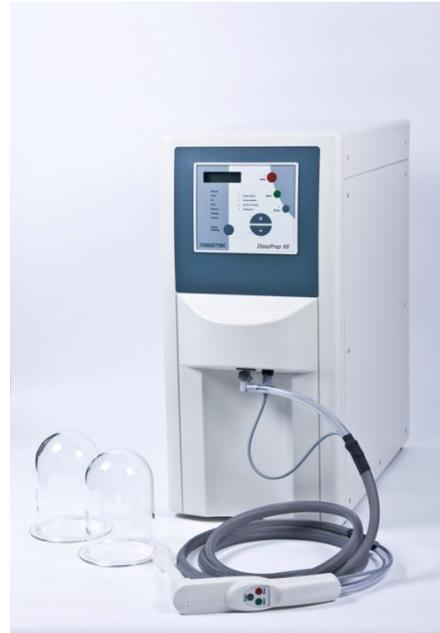
Unsere Mediumtankstelle DissoPrep (X8 oder XI5) arbeitet ohne eine Flüssigkeitspumpe! Rein über das Erzeugen von Vakuum wird angesaugt und entgast und über den Aufbau von Druck wird zusammen mit der Wägezelle gravimetrisch (nach Gewicht) dosiert.
