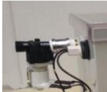
Um Ihnen trotz regulärem Absperrhahn und Druckreduzierer größtmögliche Sicherheit bezüglich einem Überfüllen des Water-Interface zu bieten, gibt es das Water-Interface nun auch mit einem zusätzlichen automatischen Absperrventil. Dieses schließt automatisch, wenn der Füllstand im Water-Interface ein kritisches Niveau erreicht hat!
